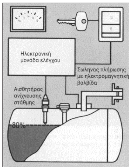
Εικόνα 7.1.6 Ηλεκτρονική διάταξη διακοπής πλήρωσης δοχείου υγραερίου με αισθητήρα στάθμης και ηλεκτρομαγνητική βαλβίδα
