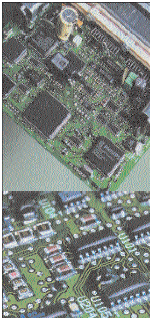
Εικόνα 3.3.2 Δομή Ηλεκτρονικής Μονάδας Ελέγχου
