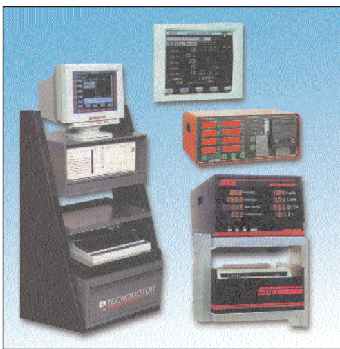
Εικόνα 5.3 Αναλυτές καυσαερίων πέντε αερίων με εκτυπωτές (κάτω)
