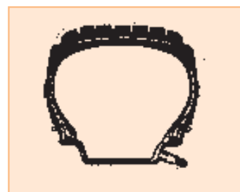
Σχήμα 4: Τομή ελαστικού με αεροθάλαμο.
