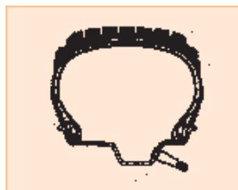
Σχήμα 3: Ελαστικό χωρίς αεροθάλαμο (TUBELESS).
