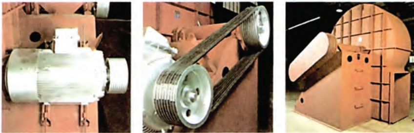
Εικ. 14.9α Ιμαντοκίνηση παραδείγματος εφαρμογής
