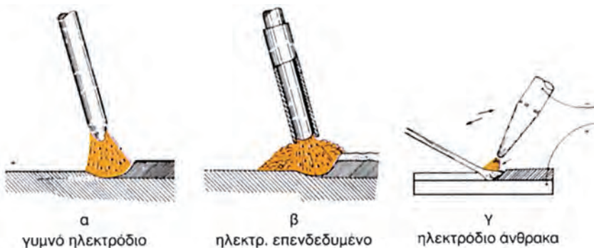
Εικ. 7.4β Συγκόλληση με ηλεκτρικό τόξο
