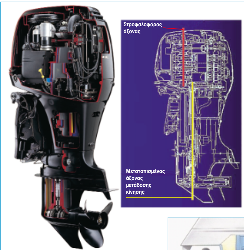
Σχήμα 6.8: Τομή εξωλέμβιας μηχανής SUZUKI, στην οποία φαίνεται μετατοπισμένος ο άξονας μετάδοσης της κίνησης, σε σχέση με τον στροφαλοφόρο άξονα.
