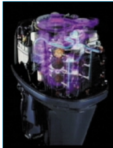
Σχήμα 6.3: Θέση τοποθέτησης του κινητήρα στο συγκρότημα της εξωλέμβιας μηχανής είναι όρθια με τον μπροστινό τμήμα της να βρίσκεται στο επάνω μέρος
