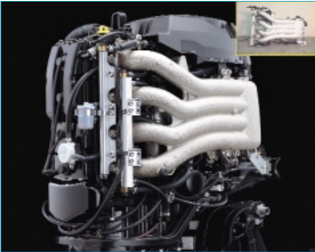
Σχήμα 6.13: Πολλαπλή εισαγωγή μεγάλου μήκους
