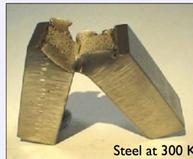
(β) Ψαθυρή και όλκιμη θραύση ίδιου υλικού
