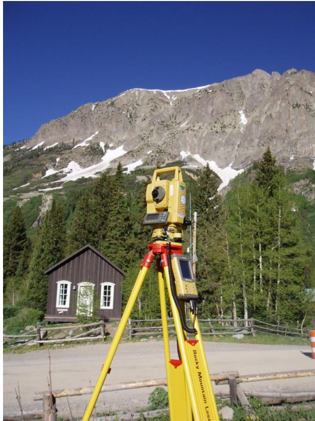
Γεωδαιτικός σταθμός ( http://www.google.com/imghp )
